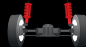
**Спортивная подвеска** с возможностью выбора жесткости амортизаторов
